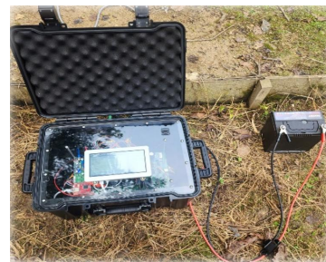
Fig. 1. 자체 개발한 국산화 전기비저항탐사 장비
