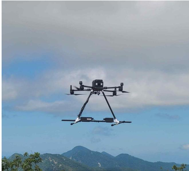
Fig. 1. 자체 개발한 국산화 드론자력탐사 시스템 및 전용 스키드
